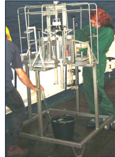
September 2001: Einsatz des Mini Muc nördlich von Spiekeroog, Deutsche Bucht; Solveig Bühring, Max-Planck-Institut Bremen; Probennahme sandiger Sedimente; Forschungsschiff: Heincke 154
