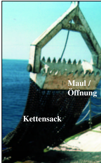
Dredge beim Einholen
